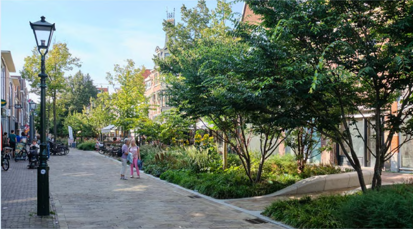
Afbeelding 115. De Laet in Alkmaar is door Bureau B+B in 2023 getransformeerd van een stenige winkelstraat met hittestress en wateroverlast tot een groene, klimaatadaptieve verblijfsruimte. Verdiepte plantvakken, bloeiende beplanting en meer dan 60 nieuwe bomen zorgen voor verkoeling, waterberging en schaduw. Zo krijgt de historische binnenstad een leefbaardere openbare ruimte met plek voor ontmoeting, terrassen en ontspanning. Foto: Bureau B+B stedenbouw en landschapsarchitectuur.
