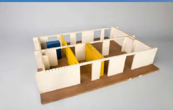
Afbeelding 26. Maquette van het interieur van een flexibele module, ontwikkeld door SAR, bestaande uit drie dragende muren en twee aanpasbare wanden. (1969–72). Beeld: Collectie Het Nieuwe Instituut Rotterdam, Archief SARE.
