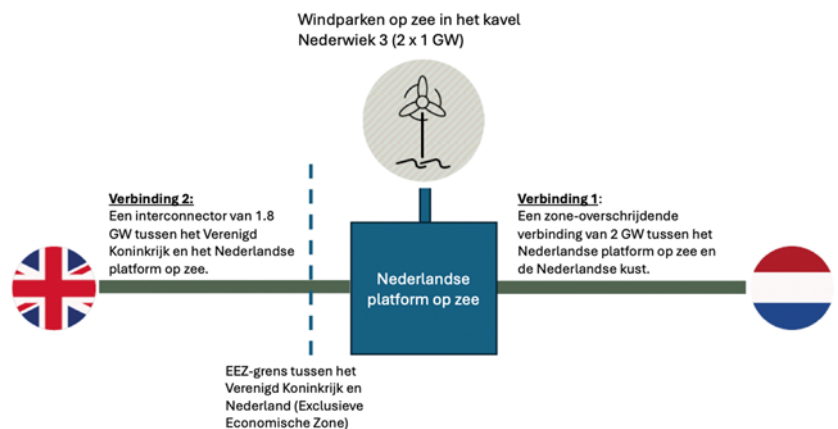
Figuur 1: opzet van de hybride interconnector, LionLink.
