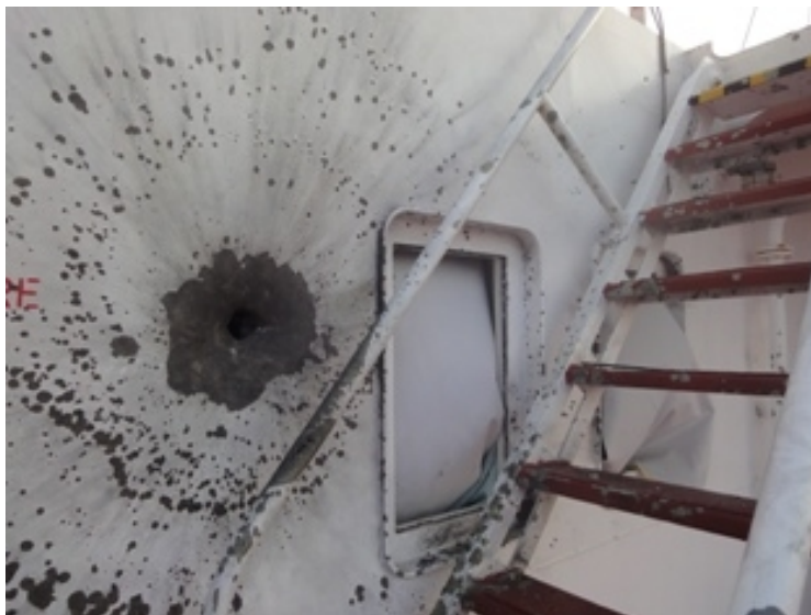
Afb. 4. De resultaten van de inslag van een granaat, uit een raketgranaatwerper, in de opbouw van een koopvaardijship.
