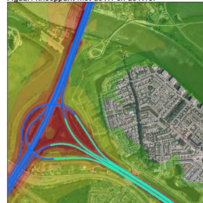
Figuur: Cumulatieve geluidcontouren van de A1 en de A10 en de verbindingswegen op het knooppunt.
